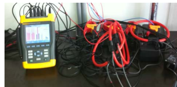
Măsurători privind regimul de funcționare a pompelor de căldură în laboratorul CESR
